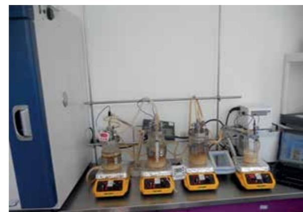
Figura 1 Sistema Simulador de tracto digestivo Humano
