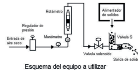
Figura 2. Esquema del sistema experimental.
