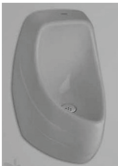
Figura 2. Fotografía del mingitorio que no usa agua fabricado en cerámica, adaptado con la trampa que usa un líquido más ligero que el agua y la orina, trampa Intertramp, que se describe en la patente MX 261809.
