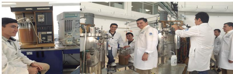
Figura 3. Fermentación de pre-inóculo 10 L, estudiantes de Maestría y Licenciatura, Dr. Gustavo Dávila (izq—der.) biorreactor de 150 L para pruebas comerciales.
