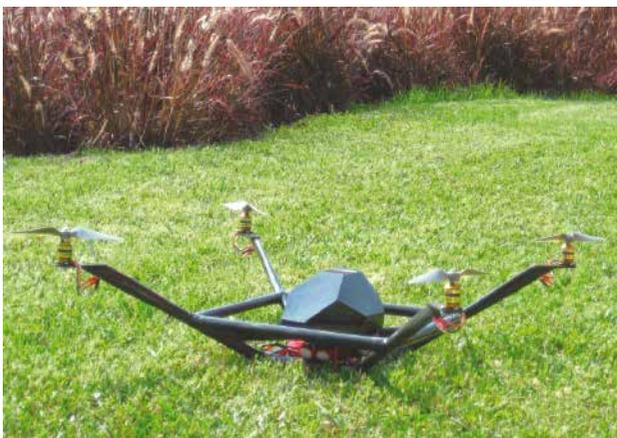
Fig. 2. Prototipo de un dron completamente funcional
